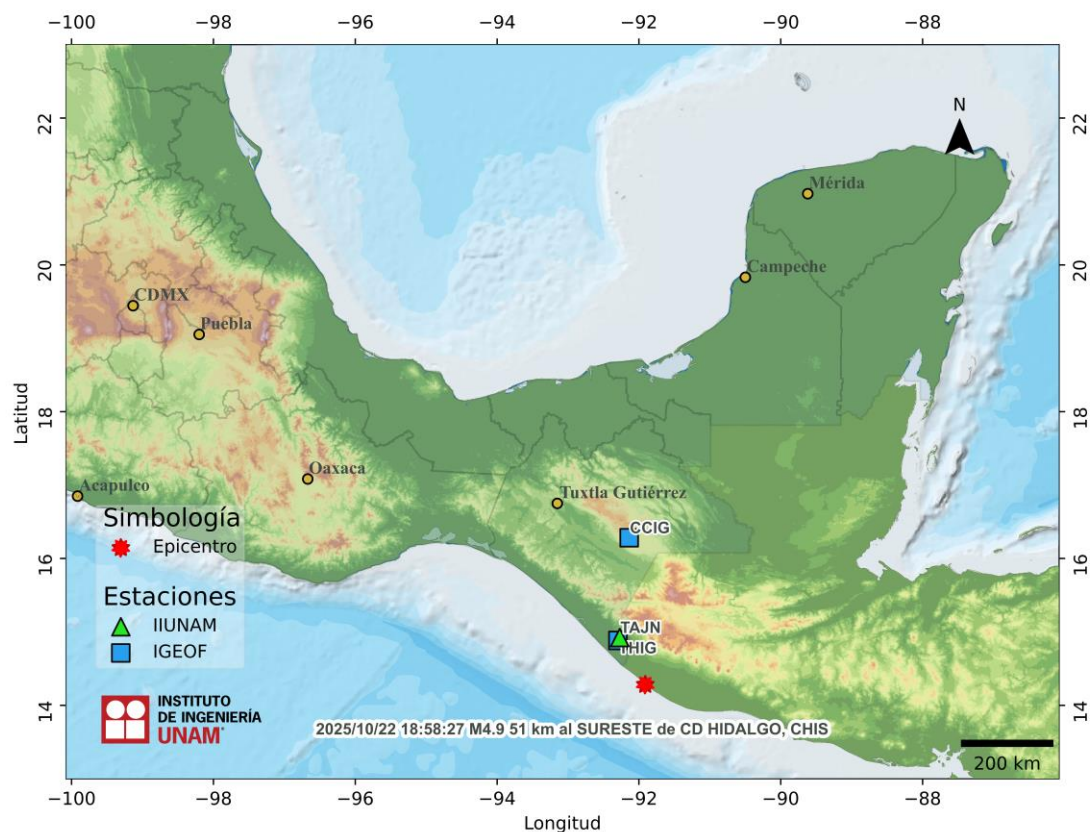
Figura 1. Epicentro del sismo del 22 de octubre de 2025 (M4.9) y estaciones sísmicas empleadas en la elaboración del mapa preliminar de PGA. Las estaciones pertenecientes a la Red Acelerográfica del Instituto de Ingeniería de la UNAM (IIUNAM) son operadas por la Unidad de Instrumentación Sísmica. Las estaciones IGEOF mostradas son operadas por el Servicio Sismológico Nacional.
