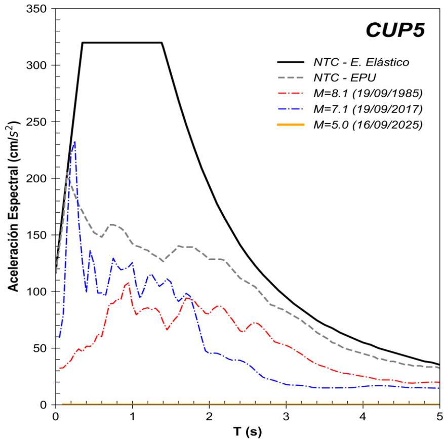
**Figura 4.** Comparación del espectro de respuesta (ER) del sismo registrado en la estación **CUP5** con el espectro elástico de diseño (EDS) y de peligro uniforme (EPU) obtenidos del SASID. La línea discontinua de color rojo y azul corresponden a los ER de los sismos del 19 septiembre de 1985 y 2017, respectivamente. Todos los ER graficados corresponden a la media cuadrática de sus componentes horizontales.
