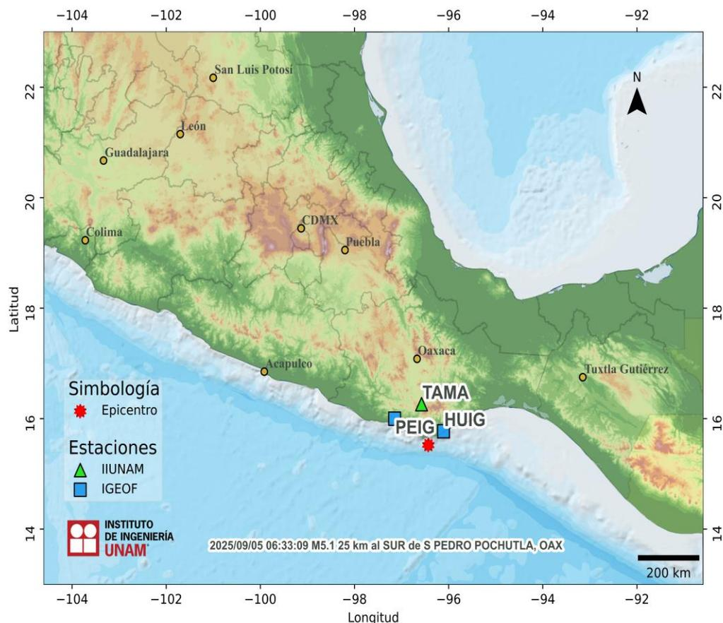
**Figura 1.** Epicentro del sismo del 05 de septiembre de 2025 (M5.1) y estaciones sísmicas empleadas en la elaboración del mapa preliminar de PGA. Las estaciones pertenecientes a la Red Acelerográfica del Instituto de Ingeniería de la UNAM (IIUNAM) son operadas por la Unidad de Instrumentación Sísmica. Las estaciones IGEOF mostradas son operadas por el Servicio Sismológico Nacional.
