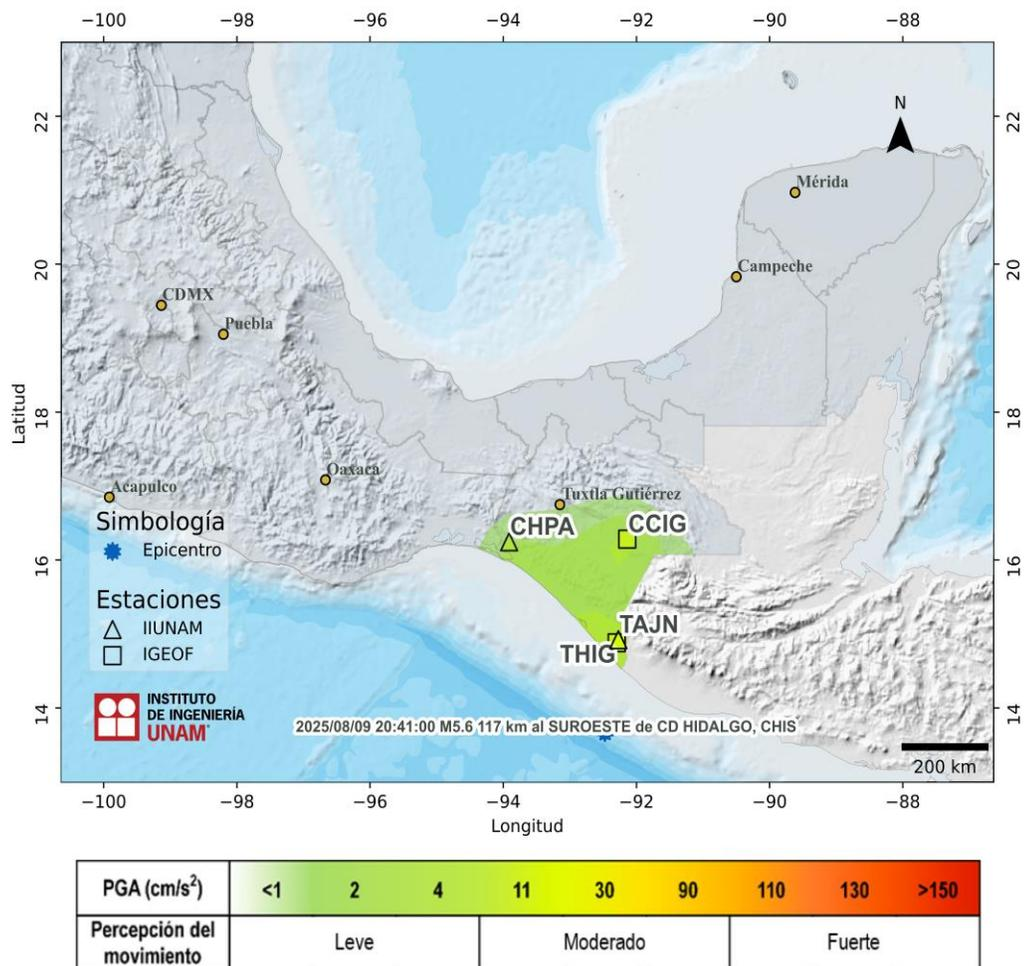
Figura 2. Mapa de intensidad de la Aceleración Máxima del Terreno (PGA<sub>rmsh</sub>)
