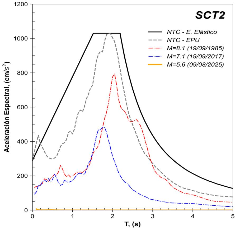
**Figura 5.** Comparación del espectro de respuesta (ER) del sismo registrado en la estación **SCT2** con el espectro elástico de diseño (EDS) y de peligro uniforme (EPU) obtenidos del SASID. La línea discontinua de color rojo y azul corresponden a los ER de los sismos del 19 septiembre de 1985 y 2017, respectivamente. Todos los ER graficados corresponden a la media cuadrática de sus componentes horizontales.
