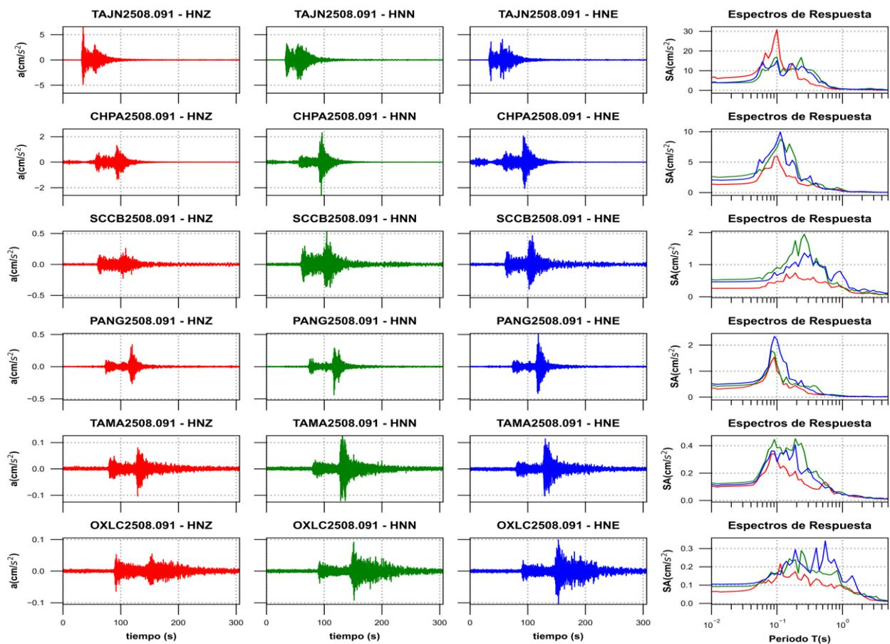
**Figura 3a.** Acelerogramas registrados y espectros de respuesta estimados para los registros obtenidos durante el sismo del 09 de agosto de 2025 (M5.6)
