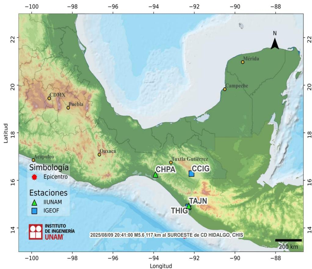
**Figura 1.** Epicentro del sismo del 09 de agosto de 2025 (M5.6) y estaciones sísmicas empleadas en la elaboración del mapa preliminar de PGA. Las estaciones pertenecientes a la Red Acelerográfica del Instituto de Ingeniería de la UNAM (IIUNAM) son operadas por la Unidad de Instrumentación Sísmica. Las estaciones IGEOf mostradas son operadas por el Servicio Sismológico Nacional.
