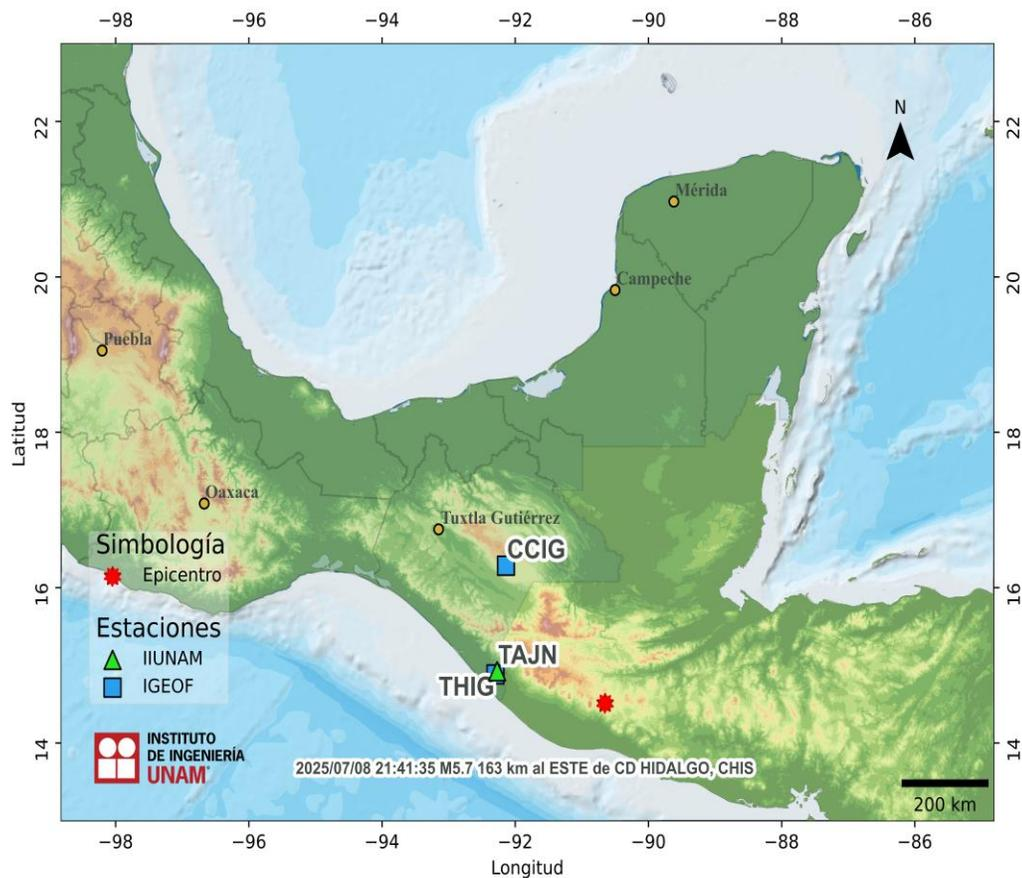
**Figura 1.** Epicentro del sismo del 08 de julio de 2025 (M5.7) y estaciones sísmicas empleadas en la elaboración del mapa preliminar de PGA. Las estaciones pertenecientes a la Red Acelerográfica del Instituto de Ingeniería de la UNAM (IIUNAM) son operadas por la Unidad de Instrumentación Sísmica. Las estaciones IGEOF mostradas son operadas por el Servicio Sismológico Nacional.
