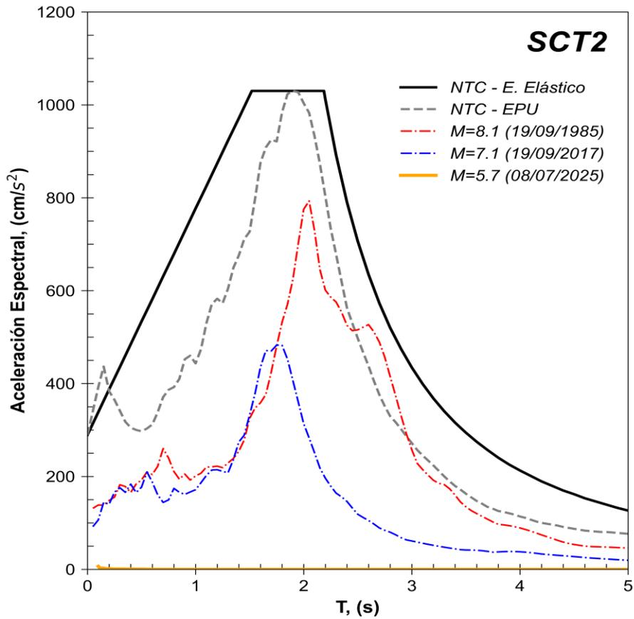
**Figura 5.** Comparación del espectro de respuesta (ER) del sismo registrado en la estación **SCT2** con el espectro elástico de diseño (EDS) y de peligro uniforme (EPU) obtenidos del SASID. La línea discontinua de color rojo y azul corresponden a los ER de los sismos del 19 septiembre de 1985 y 2017, respectivamente. Todos los ER graficados corresponden a la media cuadrática de sus componentes horizontales.
