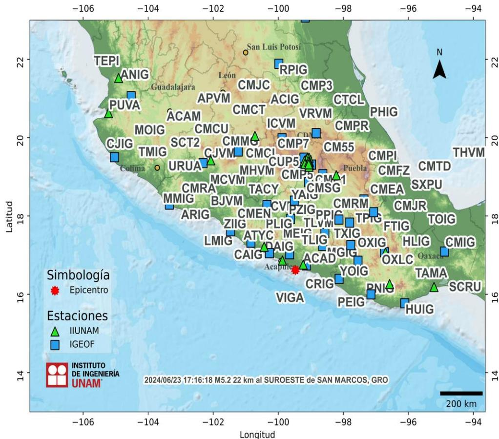
**Figura 1.** Epicentro del sismo del 23 de junio de 2024 (M5.2) y estaciones sísmicas empleadas en la elaboración del mapa preliminar de PGA. Las estaciones pertenecientes a la Red Acelerográfica del Instituto de Ingeniería de la UNAM (IIUNAM) son operadas por la Unidad de Instrumentación Sísmica. Las estaciones IGEOF mostradas son operadas por el Servicio Sismológico Nacional.
