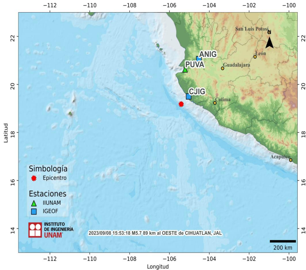
Figura 1. Epicentro del sismo del 08 de septiembre de 2023 (M5.7) y estaciones sísmicas empleadas en la elaboración del mapa preliminar de PGA. Las estaciones pertenecientes a la Red Acelerográfica del Instituto de Ingeniería de la UNAM (IIUNAM) son operadas por la Unidad de Instrumentación Sísmica. Las estaciones IGEOF mostradas son operadas por el Servicio Sismológico Nacional.
