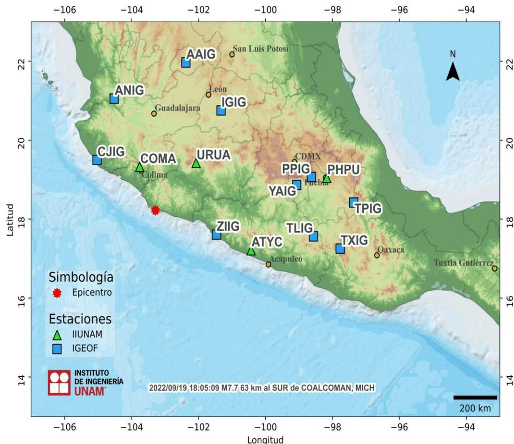
**Figura 1.** Epicentro del sismo del 19 de septiembre de 2022 (M7.7) y estaciones sísmicas empleadas en la elaboración del mapa preliminar de PGA. Las estaciones pertenecientes a la Red Acelerográfica del Instituto de Ingeniería de la UNAM (IIUNAM) son operadas por la Unidad de Instrumentación Sísmica. Las estaciones IGEOP mostradas son operadas por el Servicio Sismológico Nacional.
