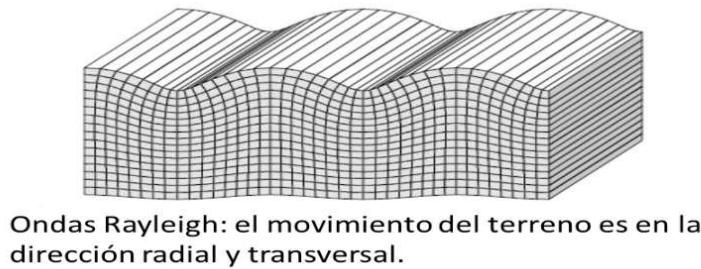
Figura 3. 4. Movimiento de la partícula para las ondas Love y Rayleigh (Modificada de Shearer, 2009).
