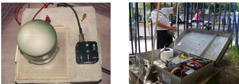
Figura 11. Izquierda) Sismómetro STS-2 y acelerómetro FBA-23 en una estación del SSN. Derecha) Estación SCT2 de la Red Acelerométrica del II.
